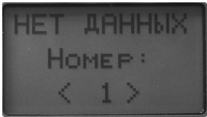
Рисунок 6.17 Отображение при незаполненной ячейке памяти.
