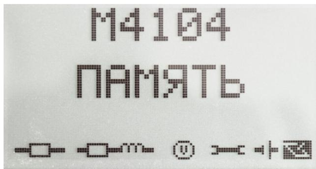
Рисунок 6.14. Видеogramма выбора режима просмотра сохраненных результатов измерения
