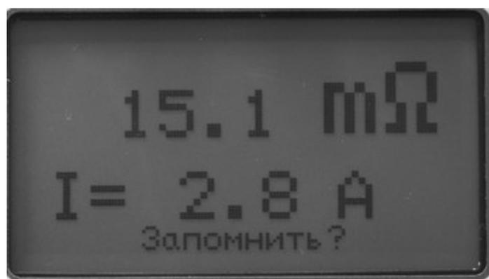
Рисунок 6.4 Видеogramма результата измерения.
